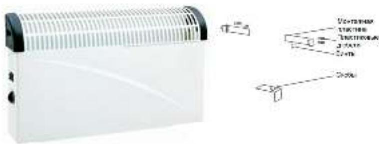
С помощью монтажного комплекта установите обогреватель на стене у пола. Расстояние между монтажными отверстиями на задней части обогревателя составляет 41,5 см. Глубина и диаметр монтажного отверстия соответственно 35 мм и 8 мм. Расстояние от прибора до пола должно быть не менее 10 см.
